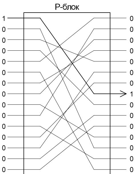
**Блок перестановок** может “обслужить” очень много линий, но он всего лишь изменяет положение цифр. Оппонент может узнать его внутреннюю коммутацию, подавая ему на вход одиночные единицы и наблюдая, на каком выходе эти единицы появляются.
