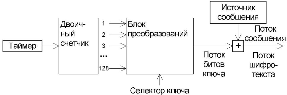
**Псевдослучайный поток** может быть получен и более сложным образом. В этом обобщенном представлении его генератора двоичный счетчик обеспечивает входными числами блок преобразований, который вырабатывает цифры ключевого потока, прибавляемые далее к потоку цифр сообщения.
