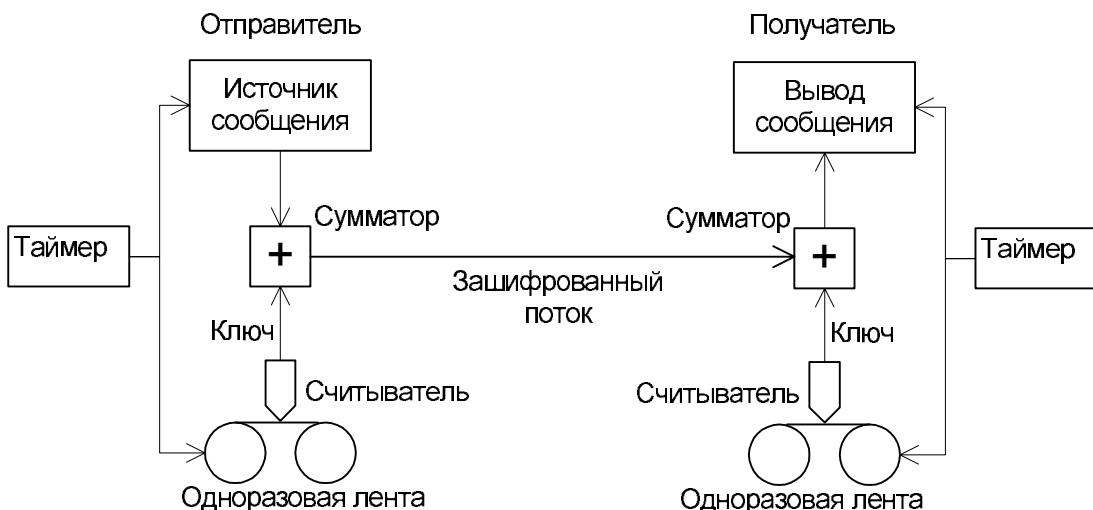
**Система “одноразовая лента”** требует, чтобы на передатчике и на приемнике были ленты с одним и тем же ключом, синхронизированные посредством таймера. Цифры сообщения и цифры ключа складываются по модулю 2, полученный в результате зашифрованный поток передается через канал связи, после чего ключ вычитается из данных (прибавляется по модулю 2). Для трафика большого объема обширные запасы ключевых цифр должны быть заблаговременно доставлены получателю и храниться у него.
